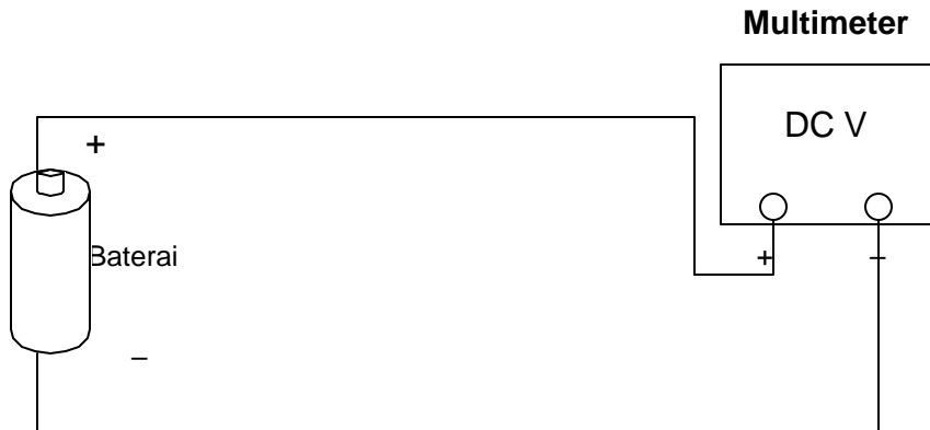
Gambar 5. Multimeter untuk Mengukur Tegangan DC
