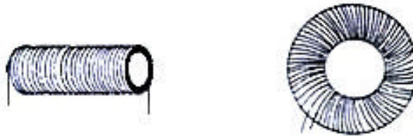
Gambar 3.4. Kumparan solenoidal dan kumparan toroidal
